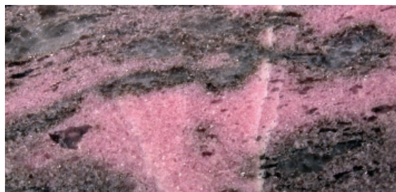
Ylistaron Vittingin rodniittikiven hiottu pinta. Kuva-alan leveys on 35 mm. Rodniittia kerroksina serttikivessä.
