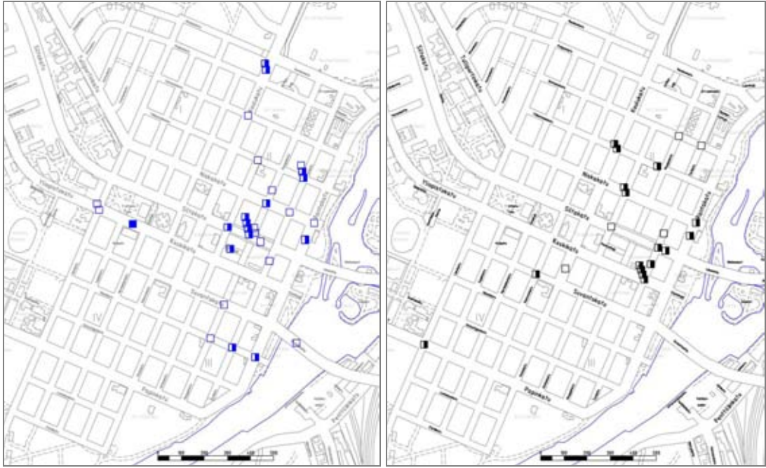
Kuva 4.19. Jalankulkuonnettomuudet 1995–1999 ennen kävelykadun rakentamista (vasen kartta) ja 2005–2009 kävelykadun rakentamisen jälkeen. Tummennetut neliöt ovat henkilövahinkoon johtaneita onnettomuuksia ja ennen tilanteen kokonaan tummennettu onnettomuus kirjaston kohdalla on johtanut kuolemaan.
