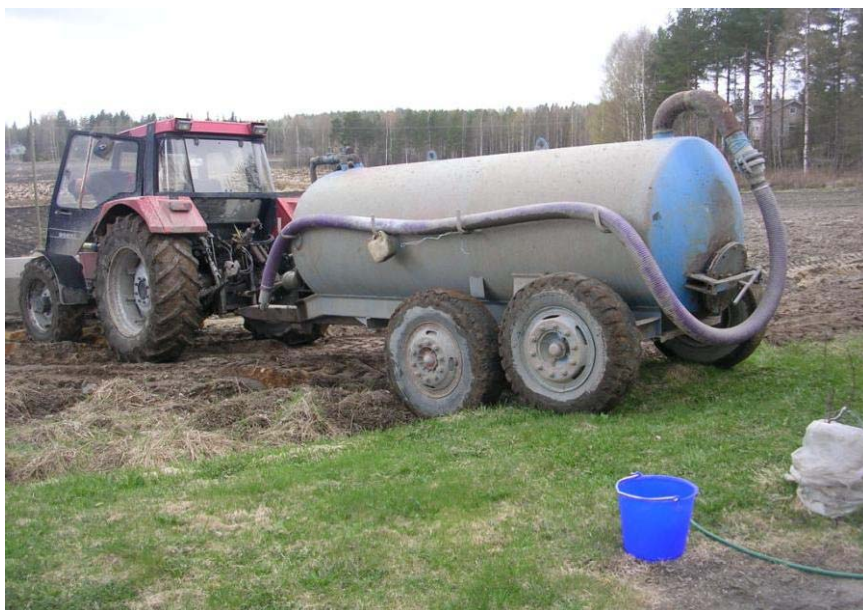
Kuva 2. Maataloudessa käytettävä imupainevaunu soveltuu hyvin kalkkistabiloinnin suorittamiseen
