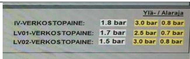
Kuva 135 etävalvotut verkostojen paineet
