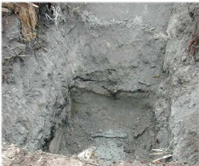
Kuva 3: Koekuoppa paalun 36 kohdalla.
