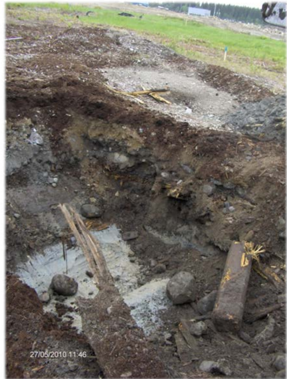
Kuva 4: Karttapisteeseen 108 (ruutu P9) tehdyssä koekuopassa todettiin täyttömaan seassa runsaasti puuta.
